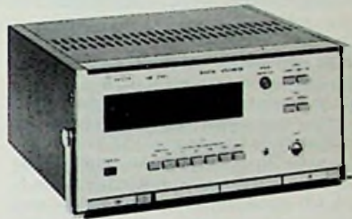
Afb. 2 De PM 2441, een digitale gelijkspanningsmeter van uitzonderlijke klasse: de gemiddelde meetfout bedraagt slechts 0,005% van de afgelezen waarde.
